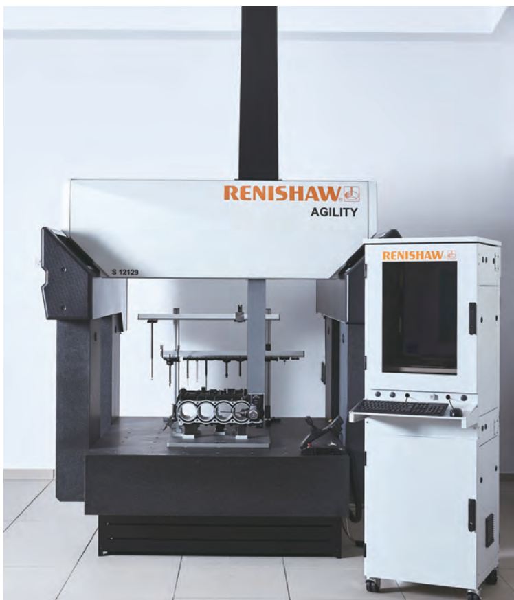
搭配 REVO 測頭的 AGILITY 5 軸同動三次元量床。 Renishaw
